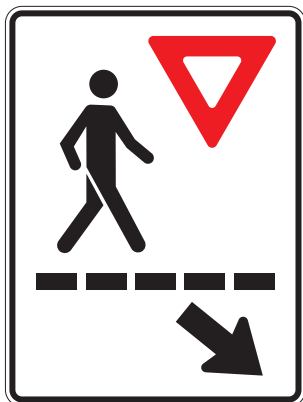
Figure 13 – Panneau de signalisation de passage pour piétons Crédit image : MTQ
